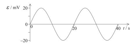
Se reduce a la mitad la frecuencia de rotación del generador. ¿Cuál de las siguientes gráficas mostrará correctamente la variación de la nueva f.e.m. inducida,  $\varepsilon$ , como función del tiempo?
