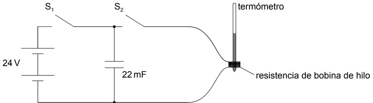
Una fuente de alimentación de f.e.m. 24 V y resistencia interna despreciable se conecta a un capacitor y a una resistencia de bobina de hilo, utilizando un montaje con dos interruptores. Se cierra el interruptor  $S_1$  y, unos segundos después, se abre. Entonces se cierra el interruptor  $S_2$ .
