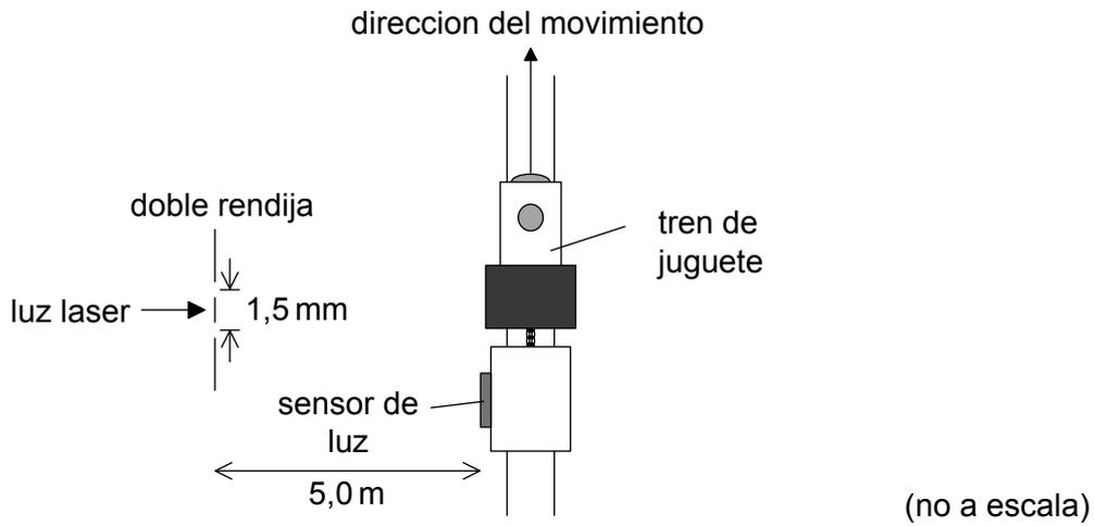
La luz de un láser incide sobre una doble rendija. Un sensor de luz ligado al tren detecta la luz procedente de las rendijas.
