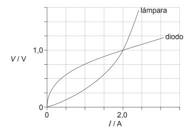
¿Cuál es la resistencia de la lámpara y la resistencia del diodo cuando la corriente en cada dispositivo es de 2,0A?
