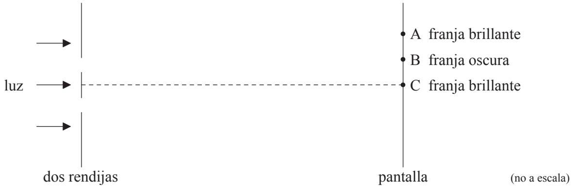
En C se produce una franja brillante central. La siguiente franja brillante se produce en A y hay una franja oscura en B.
