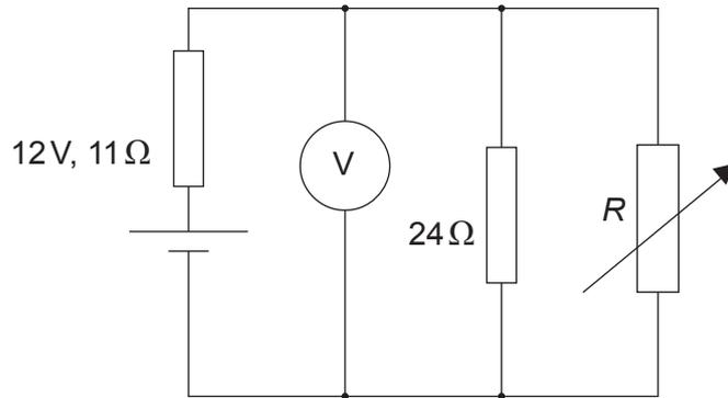
Las fuentes de potencia suministran la máxima potencia a un circuito externo cuando la resistencia del circuito externo es igual a la resistencia interna de la fuente de potencia.
