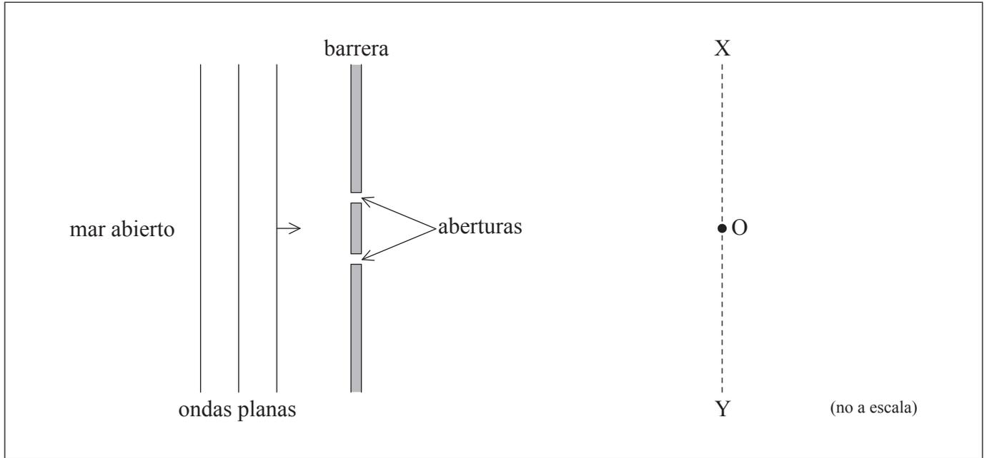
Ondas planas de agua procedentes del mar abierto inciden sobre la barrera, y las aberturas actúan como fuentes puntuales de ondas. La distancia desde las aberturas hasta XOY es mucho mayor que la longitud de onda de las ondas. El punto O equidista de las aberturas.
