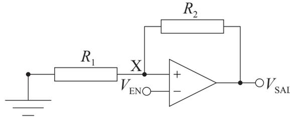
Los voltajes suministrados al amplificador operacional son +15 V y -15 V. Los resistores tienen valores de  $R_1 = 47 \text{ k}\Omega$  y  $R_2 = 420 \text{ k}\Omega$ .
