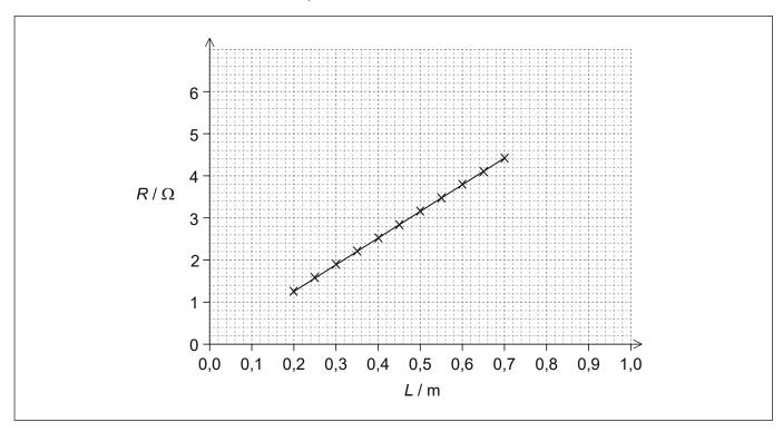
La pendiente de la línea de ajuste óptimo es  $6,30 \,\Omega\,\text{m}^{-1}$ .
