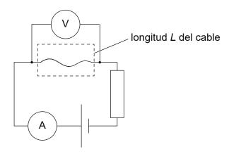
(a) En un experimento, el cable tiene un diámetro uniforme de d = 0,500 mm. El gráfico muestra los datos obtenidos para la variación de R con L.
